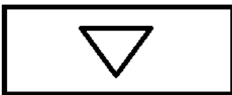
Rys. 4. Oznaczenie stanu „wyłącznik wyzwolony”.
